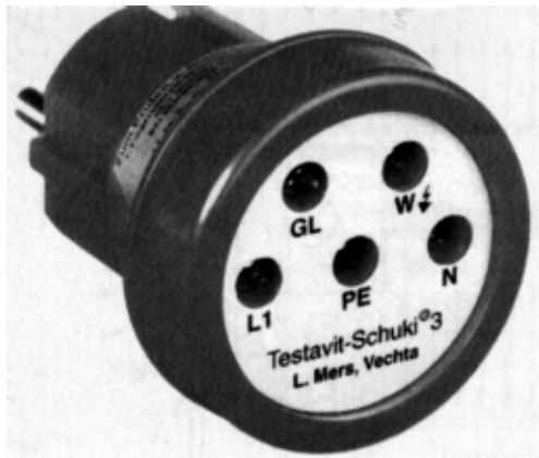
ABB. 30: SPEZIALPRÜFSTECKER „SPÜRHUND“ ZUM AUFSPÜREN VON ANSCHLUSSFEHLERN. IN EINE STECKDOSE EINGESTECKT ZEIGEN 5 LÄMPCHEN DIE RICHTIGE UND FALSCH E POLUNG DER STROMLEITUNG UND FEHLLENDE ERDUNG. (KÖNIG 2000)
